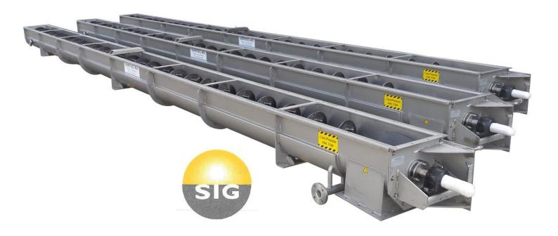
Wir haben von der Firma SIG (Services Industriels de Genève) den Auftrag zur Lieferung von drei Stück Kühlschnecken erhalten. Die Gehäuse haben einem Doppelmantel und sind in Stahl rostfrei. Zum Abkühlen des Klärschlamm- Granulates wird der Doppelmantel mit kühlem Wasser beaufschlagt. Eintritts-Temperatur des Granulates ist ca.110°C und wird während der Förderung von 11000 mm auf eine Temperatur von ca.50°C abgekühlt. Die Schneckenwellen DN400 sind aus Stahl Hardox mit Zwischenlagerung.
